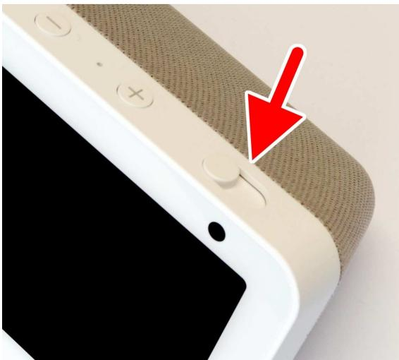
Auf die Befürchtungen vieler Nutzer, dass sie durch die eingebaute Kamera ausspioniert werden, hat Amazon beim Echo Show 5 und 8 mit einer Mechanik reagiert, welche die Kameralinse bei Bedarf abdeckt (Pfeil).
