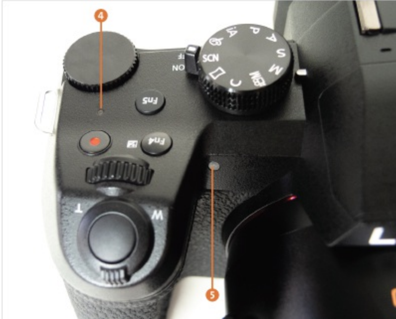
Abbildung 1.11 Die Ladelampe und die Selbstausslöser-Anzeige wirken unscheinbar, sind im Betrieb aber gut zu erkennen.
