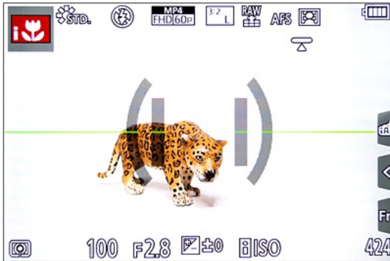
Abbildung 1.14 Nivellieranzeige mit allen Einblendungen
